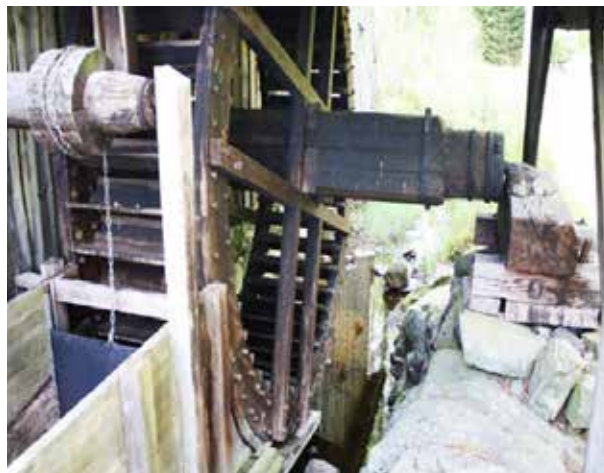
Oxebo vattensåg med ränna, vattenhjul och hjulaxel. Restaurerad sågkvarn från sent 1700-tal. (Foto: Länsstyrelsen i Jönköpings län)
