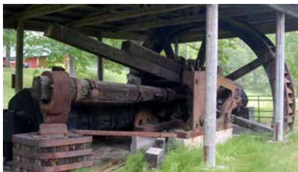
Stångjärnshammare i smedjan i Svartå, Degerfors (bild från Wikimedia)
